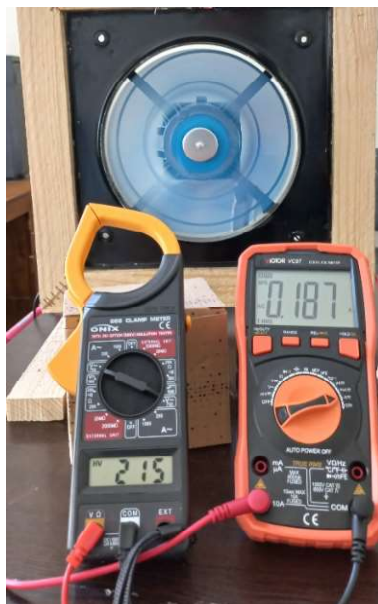
شکل ۳: اندازه گیری توان الکتریکی دمنده
