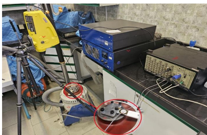
شکل ۴. تجهیزات آزمایش: (الف) دیتالاگر B&K PULSE Type ۳۵۶۰-D؛ (ب) مجموعه تقویت‌کننده Tira BDA ۱۳۰۰-E؛ (پ) ویبرومتر لیزری OMETRON VH۳۰۰؛ (ت) لرزاننده الکترومغناطیسی Tira S ۵۲۲۰-۱۲۰؛ (ث) نمای بزرگ‌نمایی شده از لرزاننده الکترومغناطیسی.
