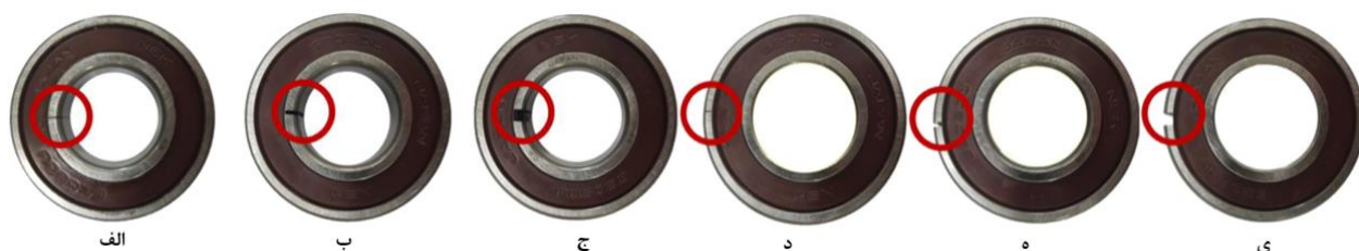
شکل ۲. عیوب مصنوعی ایجاد شده روی یاتاقان غلتشی NSK 6205 (الف تا ج: عیب رینگ داخلی در ۳ سطح مختلف و د تا ی: عیب رینگ خارجی در ۳ سطح مختلف) [۹]
