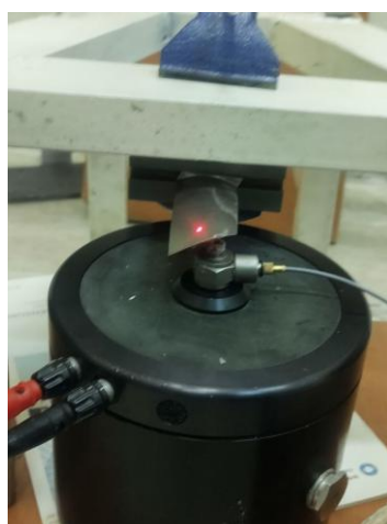
شکل ۳. چیدمان آزمایشگاهی تست غیر مخرب LDV.
