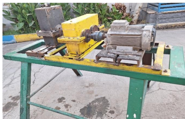
شکل ۲: سمت راست، سامانه طراحی شده با استفاده از نرم‌افزار CATIA. سمت چپ، سامانه ساخته شده مورد استفاده به منظور تخمین عمر مفید باقیمانده جعبه‌دنده.
